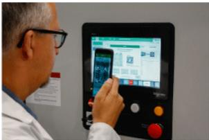
L'unità ATV6000 presenta un'interfaccia per codici QR intuitiva e facile da utilizzare per fornire all'operatore importanti informazioni sul variatore. Con una sola scansione del codice QR sulla targhetta o sullo schermo HMI tramite un dispositivo mobile (ad esempio, un tablet o uno smartphone), è possibile accedere facilmente alla documentazione tecnica o all'assistenza tecnica online per un'agevole gestione degli errori.
