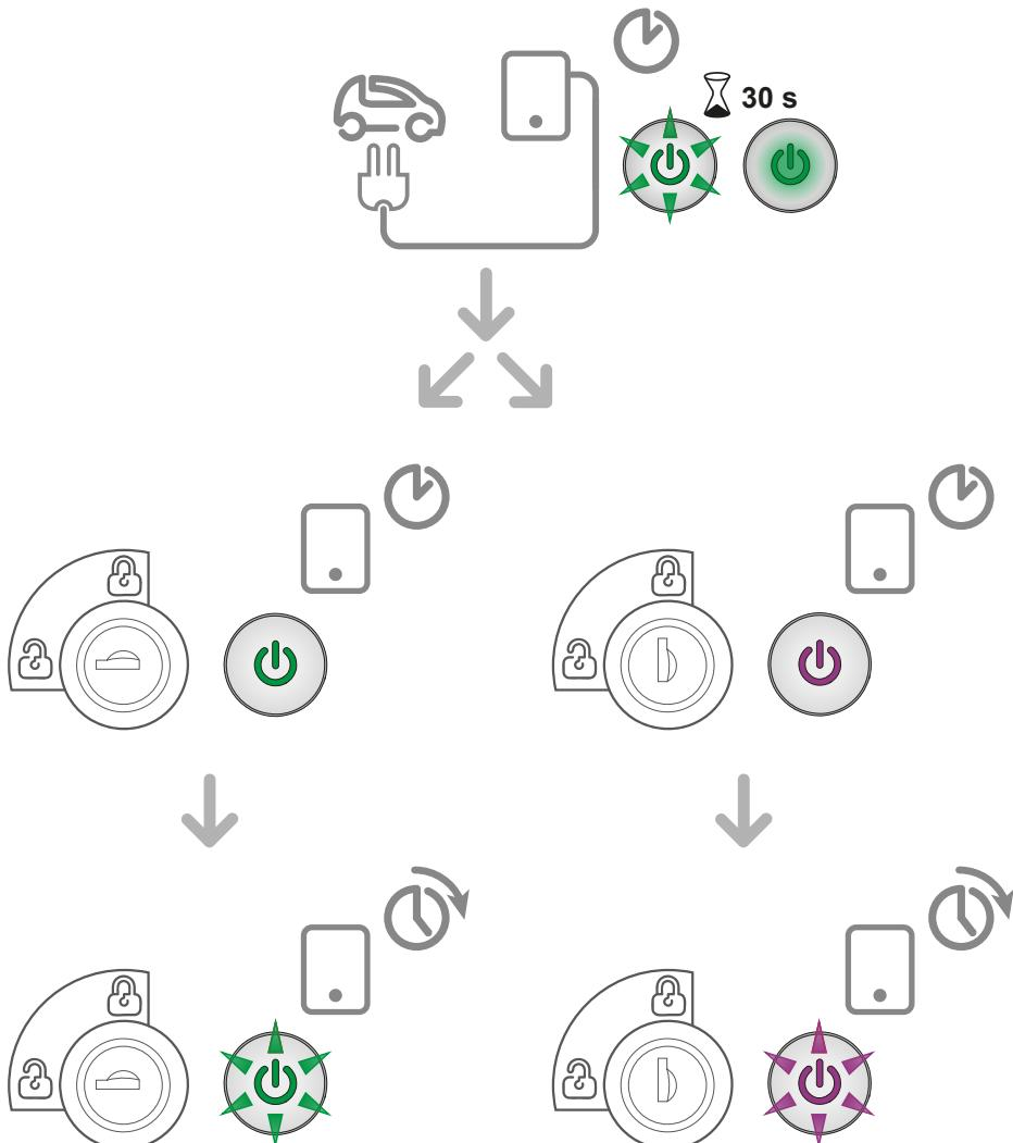
3.3 Töltés indítása: kényszerített üzem a töltőállomás felőli időzített töltés során /
