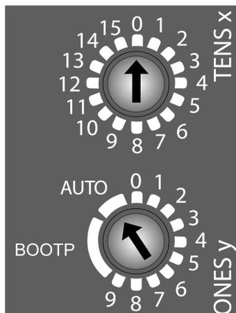
**NOTA:** Si lo desea, también puede configurar la dirección IP mediante el servidor web. La dirección IP configurada mediante el servidor web solo se tendrá en cuenta si el conmutador rotativo se encuentra en la posición **AUTO**. Si utiliza EcoStruxure Machine Expert - Basic, consulte Acoplador de bus Modicon TM3 (EcoStruxure Machine Expert - Basic) - Guía de programación. Si utiliza EcoStruxure Machine Expert, consulte Acoplador de bus Modicon TM3 - Guía de programación.
