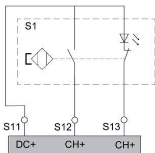
Si el nivel en el borne S12 es lógicamente 0 y el nivel en el borne S13 es lógicamente 1, la entrada relacionada con la seguridad se activa.
