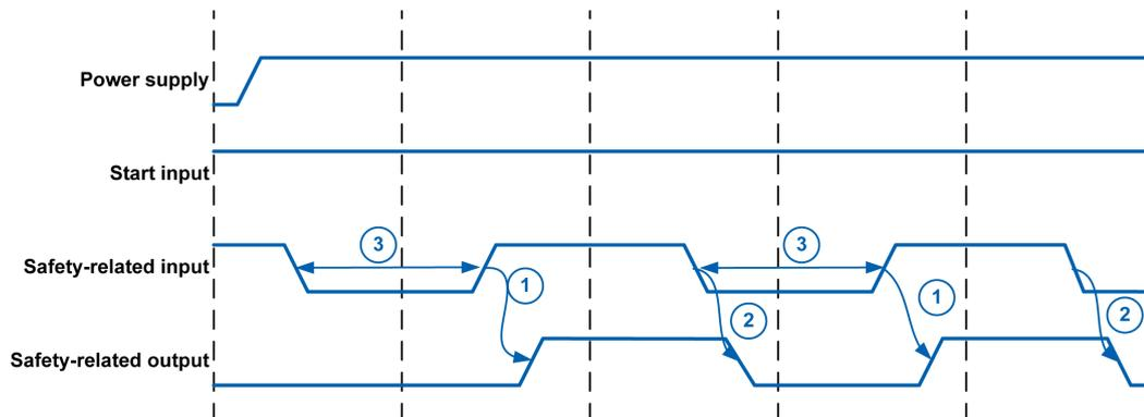
**1** Retardo de activación (100 ms): tiempo entre la activación de la entrada relacionada con la seguridad y la activación de la salida relacionada con la seguridad
