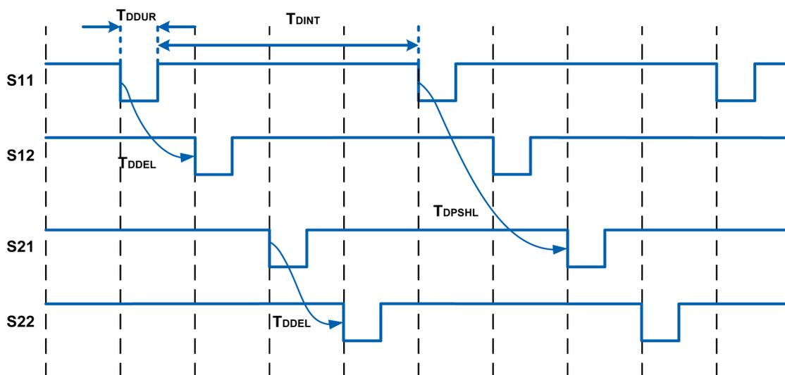
El diagrama presenta los canales de entrada S11-S12 y S21-S22. Los canales de entrada restantes S13 y S23, así como las entradas relacionadas con la seguridad restantes S31-S32-S33, S41-S42-S43, S51-S52-S53 y S61-S62-S63 utilizan la misma lógica que los canales de entrada y las entradas relacionadas con la seguridad que se muestran a continuación.
