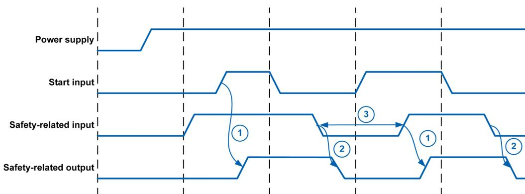
**1** Retardo de activación (100 ms): tiempo máximo entre la activación de la entrada relacionada de arranque y la activación de la salida relacionada con la seguridad
