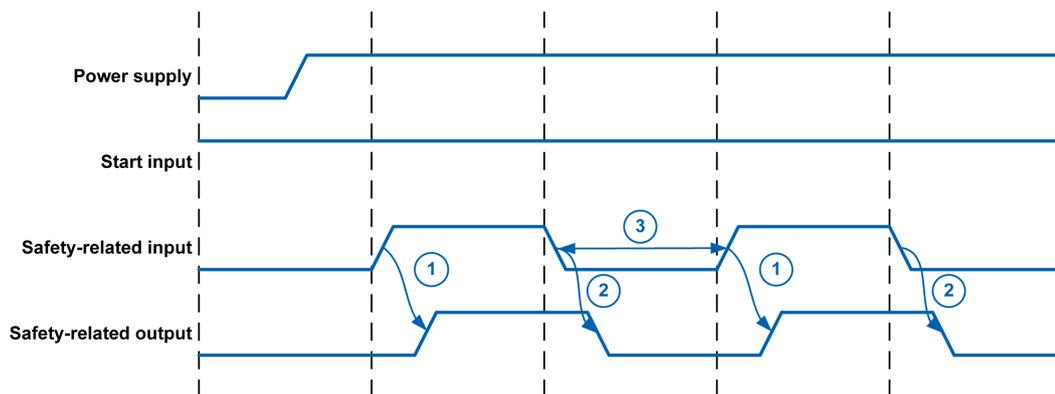
**1** Retardo de activación (100 ms): tiempo máximo entre la activación de la entrada relacionada con la seguridad y la activación de la salida relacionada con la seguridad
