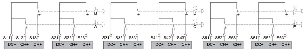
Verdrahtung der Eingänge für Schutzvorrichtungen
