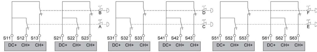
Verdrahtung der Eingänge für Schutzvorrichtungen
