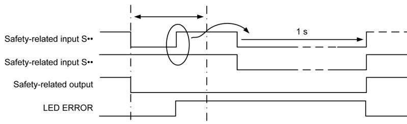
Der erste sicherheitsbezogene Eingang wird deaktiviert, wodurch die Signalverriegelungs-Überwachungszeit von 200 ms beginnt. Er wird dann erneut aktiviert, bevor der zweite sicherheitsbezogene Eingang deaktiviert wird. Dadurch wird sofort ein Signalverriegelungsalarm ausgelöst, selbst wenn die 200 ms noch nicht verstrichen sind.
