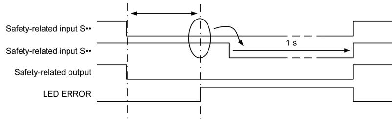
Der erste sicherheitsbezogene Eingang wird deaktiviert, wodurch die Signalverriegelungs-Überwachungszeit von 200 ms beginnt. Der zweite sicherheitsbezogene Eingang bleibt länger als 200 ms aktiviert. Dadurch wird 200 ms nach Beginn der Verriegelungsüberwachung ein Signalverriegelungsalarm ausgelöst.
