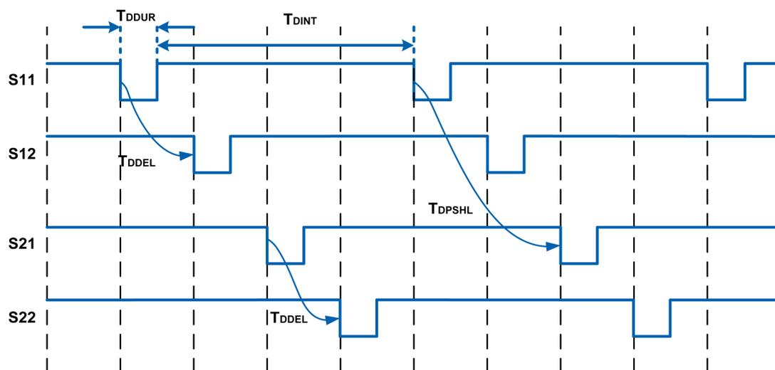
Im Diagramm sind die Eingangskanäle S11-S12 und S21-S22 dargestellt. Die übrigen Eingangskanäle S13 und S23 sowie die übrigen sicherheitsbezogenen Eingänge S31-S32-S33, S41-S42-S43, S51-S52-S53 und S61-S62-S63 verwenden die gleiche Logik wie die dargestellten Eingangskanäle und sicherheitsbezogenen Eingänge.
