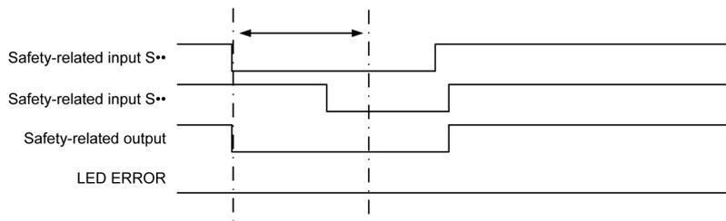
Beide sicherheitsbezogenen Eingänge werden innerhalb der Signalverriegelungs-Überwachungszeit von 200 ms deaktiviert. Wenn sie erneut aktiviert werden, werden die sicherheitsbezogenen Ausgänge ebenfalls aktiviert.
