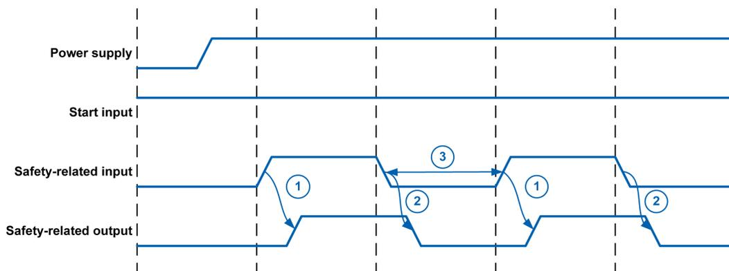
**1** Délai d'activation (100 ms) : délai maximum entre l'activation de l'entrée de sécurité et l'activation de la sortie de sécurité
