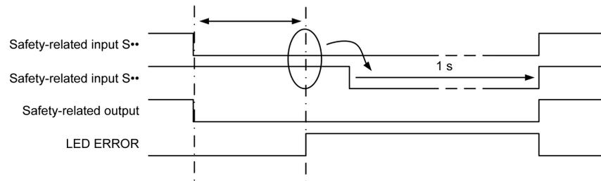
La première entrée liée à la sécurité est désactivée, ce qui lance le décompte du temps de surveillance du verrouillage de signal (200 ms). La deuxième entrée liée à la sécurité reste activée pendant plus de 200 ms. Cela déclenche une alerte de verrouillage de signal 200 ms après le démarrage de la surveillance de verrouillage.
