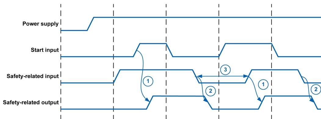
**1 Délai d'activation (100 ms) :** temps maximum entre l'activation de l'entrée de démarrage et l'activation de la sortie liée à la sécurité
