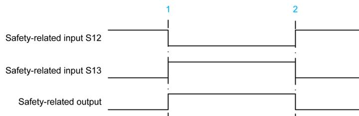
1 = Activation, passage à l'état de fonctionnement Run: Outputs Energized
