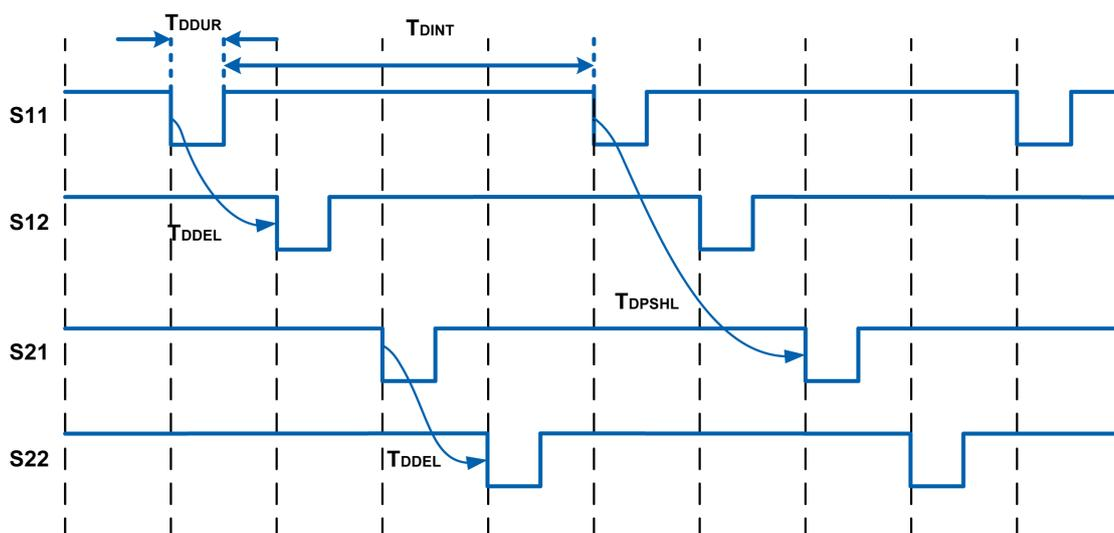
Cette figure présente les voies d'entrée S11-S12 et S21-S22. Les autres voies d'entrée S13 et S23 utilisent la même logique que les voies d'entrée illustrées.
