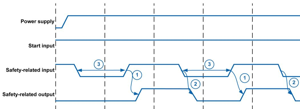
**1** Délai d'activation (100 ms) : temps entre l'activation de l'entrée liée à la sécurité et l'activation de la sortie liée à la sécurité
