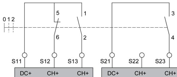
Fonctionnement des contacts d'un commutateur de mise en oeuvre à trois positions :
