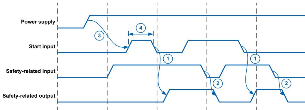
**1** Délai d'activation (100 ms) : temps maximum entre la désactivation de l'entrée de démarrage et l'activation de la sortie liée à la sécurité
