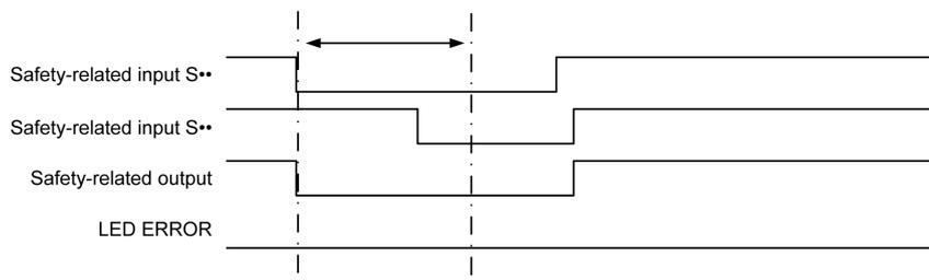
Les deux entrées liées à la sécurité sont désactivées dans le temps de surveillance du verrouillage de signal de 200 ms. Lorsqu'elles sont réactivées, les sorties liées à la sécurité sont également activées.
