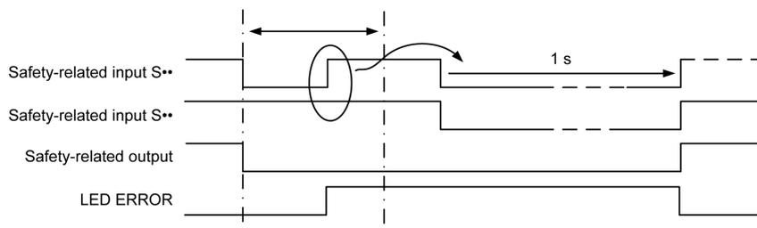
La première entrée liée à la sécurité est désactivée, ce qui lance le décompte du temps de surveillance du verrouillage de signal (200 ms). Elle est ensuite réactivée avant que la deuxième entrée liée à la sécurité ne soit désactivée. Cela déclenche immédiatement une alerte de verrouillage de signal, même si les 200 ms ne sont pas encore écoulées.
