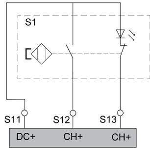
Si le niveau à la borne S12 est logiquement 0 et que le niveau à la borne S13 est logiquement 1, l'entrée liée à la sécurité est activée.
