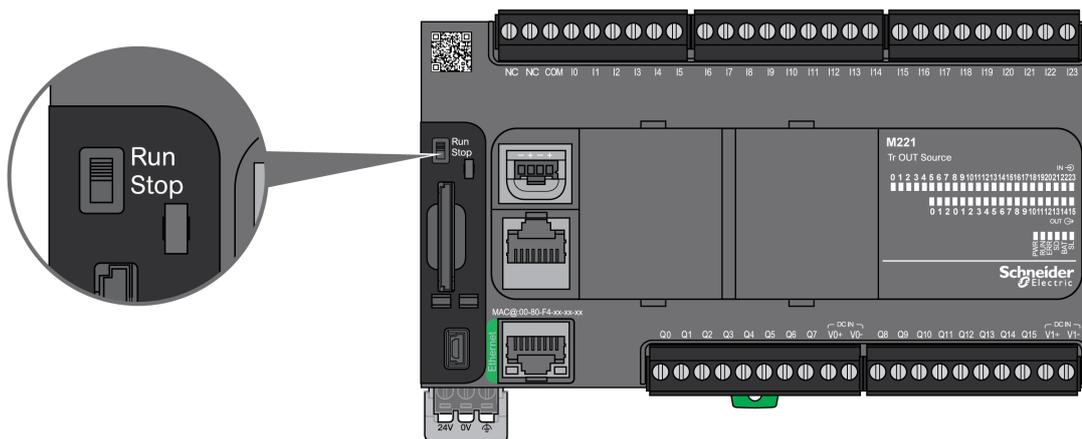
La figure suivante montre l'emplacement de l'interrupteur Run/Stop sur le TM221M Logic Controller :
