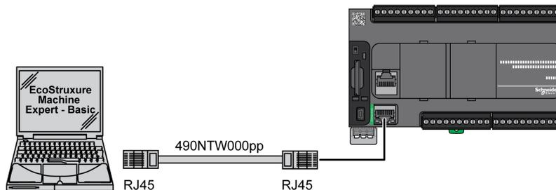
L'illustration suivante montre le raccordement Ethernet à un PC sur un TM221M Logic Controller :
