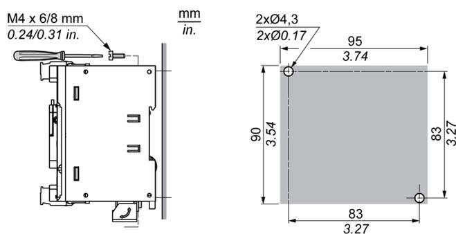
Le schéma ci-dessous représente la position des trous de montage pour TM221C Logic Controller avec 24 voies d'E/S :
