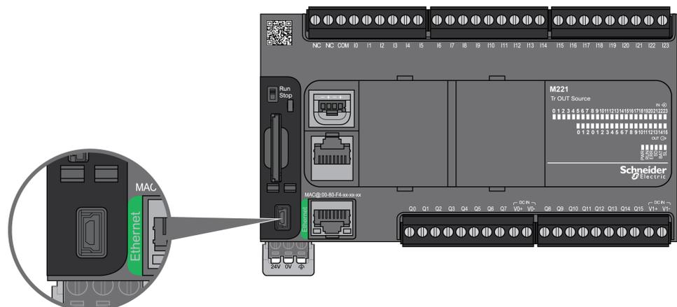
La figure suivante montre l'emplacement du port de programmation USB Mini-B sur le TM221M Logic Controller :
