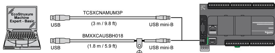
L'illustration suivante montre le raccordement USB à un PC sur un TM221M Logic Controller :
