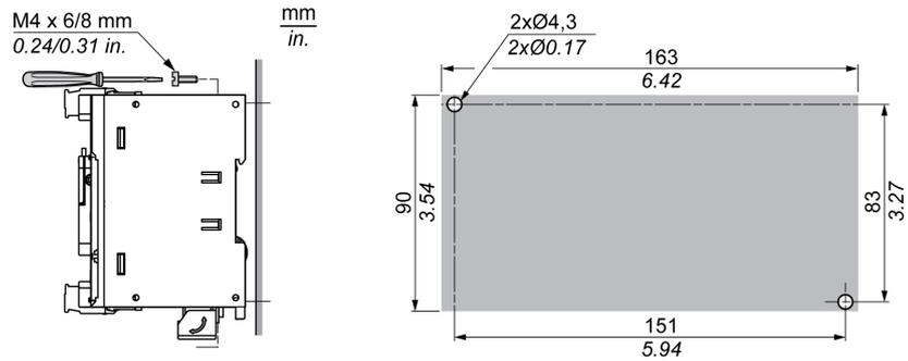
Le schéma ci-dessous indique la position des trous de montage du TM221M Logic Controller :
