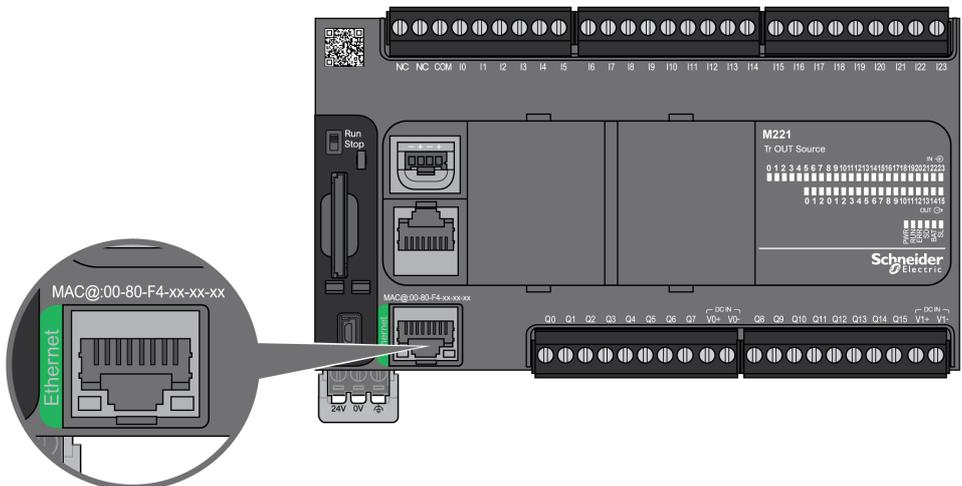
La figure suivante montre l'emplacement du port Ethernet sur le TM221M Logic Controller :
