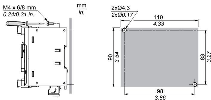
Le schéma ci-dessous représente la position des trous de montage pour TM221C Logic Controller avec 40 voies d'E/S :
