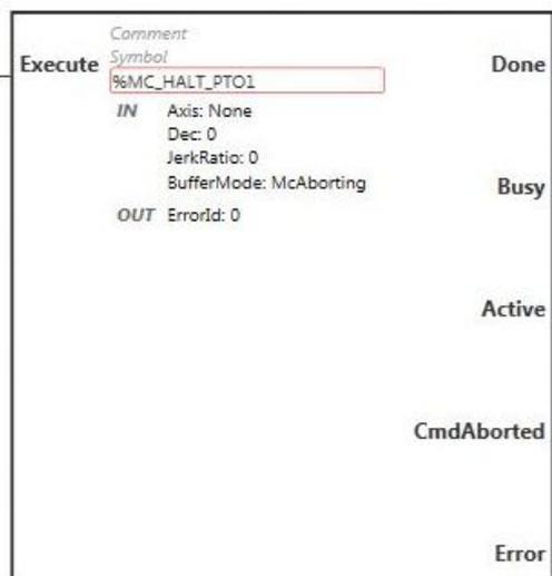
**NOTA:** Ao inserir o primeiro bloco de funções, você deverá configurá-lo para usar o eixo pretendido. Clique duas vezes no bloco de funções para exibir as propriedades do bloco de funções, escolha o eixo e clique em **Aplicar**.
