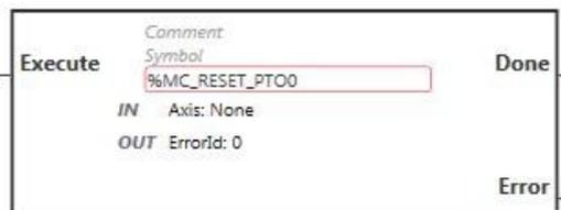
**NOTA:** Ao inserir o primeiro bloco de funções, você deverá configurá-lo para usar o eixo pretendido. Clique duas vezes no bloco de funções para exibir as propriedades do bloco de funções, escolha o eixo e clique em **Aplicar**.
