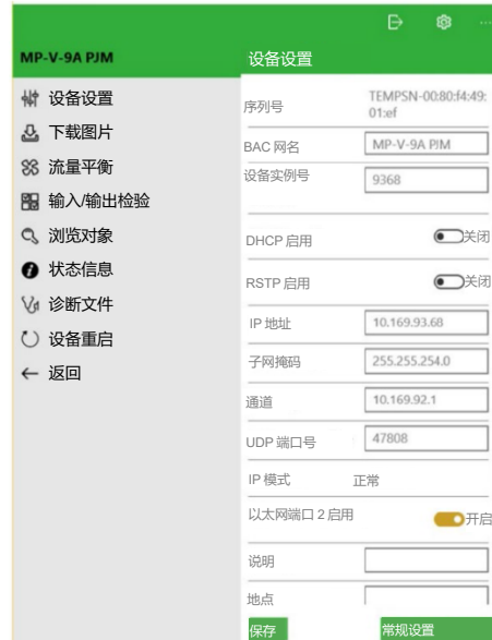
图 3 所示为 BMS 现场控制器移动调试应用的截图。
