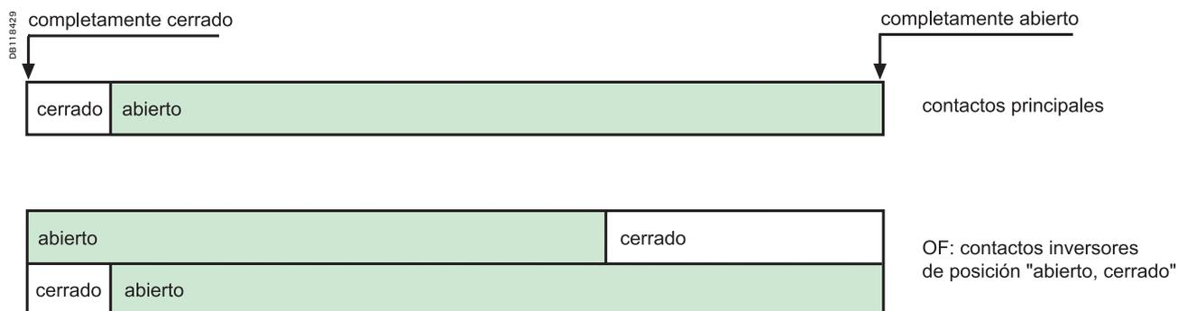
Descubrir el funcionamiento de los contactos en comparación con las posiciones "enchufado", "test" o "desenchufado" del chasis
