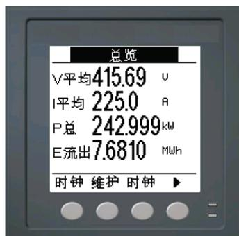
**电力系统**屏幕是 PM5111 型号测量仪的默认屏幕。
