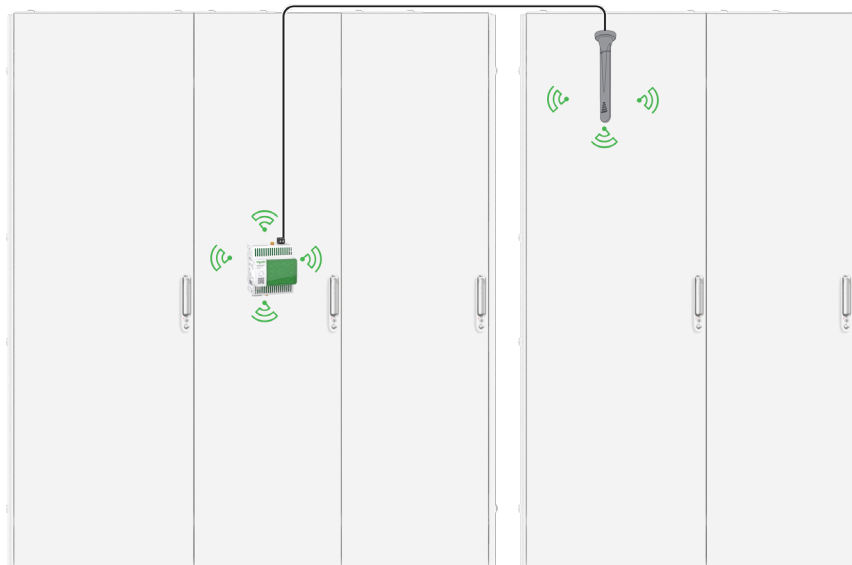
Abbildung 7: Einbau von Panel-Server und Antenne in zwei Metallgehäusen
