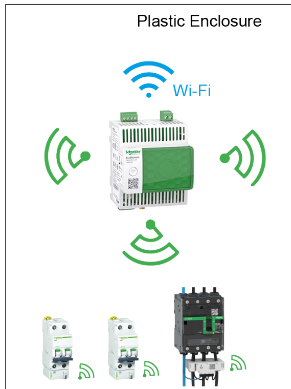
Abbildung 11: Panel-Server über interne Antenne mit WLAN verbunden
