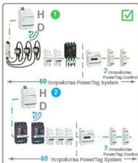
В примерах 2 и 3 датчики PowerTag Energy или модули PowerTag Control не сбалансированы между двумя шлюзами.
