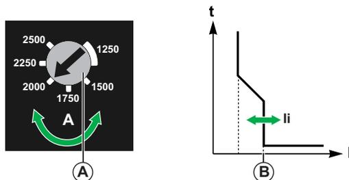
下表显示了与  $I_i$  旋钮位置相应的磁保护的吸合电流  $I_i$  值 ( 安培 ) ( 值通过旋钮指示 )：
