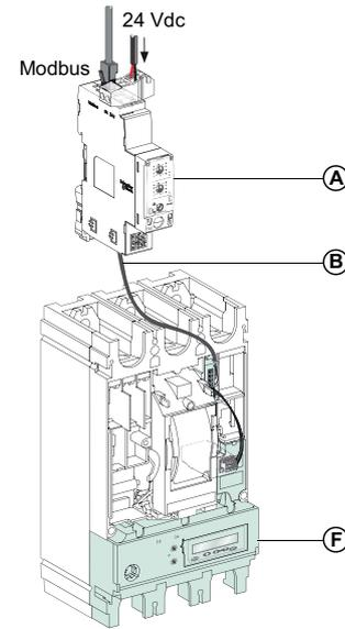
示例 3：将 IFM 通讯接口连接到 BSCM Modbus SL/ULP 模块
