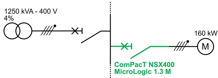
使用根据相关法规进行的安装计算来决定要安装的相应 ComPacT NSX 断路器的特性 ( 此计算使用 Ecostruxure Power Design – Ecodial 软件来执行 )。
