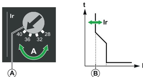
下表显示了对应每一个脱扣单元额定值、与旋钮  $I_r$  位置相应的热保护吸合电流  $I_r$  值（安培）（值通过旋钮指示）。
