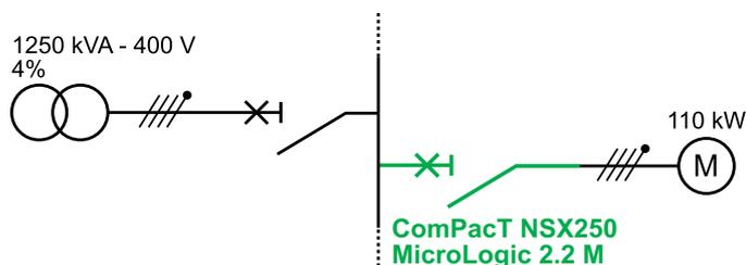
根据相关法规进行的安装计算决定了要安装的相应 ComPacT NSX 的特性（此计算使用 Ecostruxure Power Design – Ecodial 软件来执行）。
