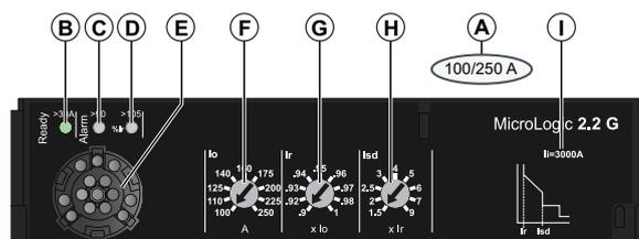
**A** MicroLogic 2G 电子脱扣单元设置范围
