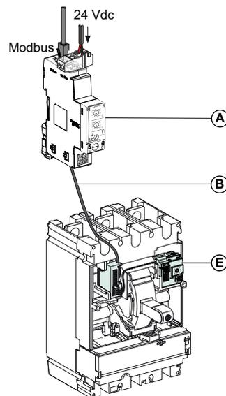
示例 4：将 IFM 通讯接口连接到 BSCM Modbus SL/ULP 模块及 MicroLogic 5、6 或 7 脱扣单元
