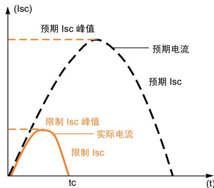
ComPacT NSX 系列具有出色的限流能力，这得益于其采用的旋转双断点技术（触点以极快的速度分断，连续出现两个电弧电压，波前非常陡）。
