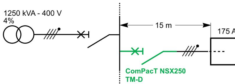
可以使用根据相关法规进行的安装计算来决定要安装的相应 ComPacT NSX 断路器的特性（此计算使用 Ecostruxure Power Design – Ecodial 软件来执行）。
