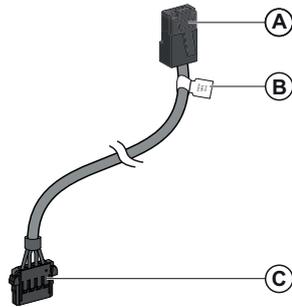
**A** 用于连接到 Modbus SL 集线器的 RJ45 插头
