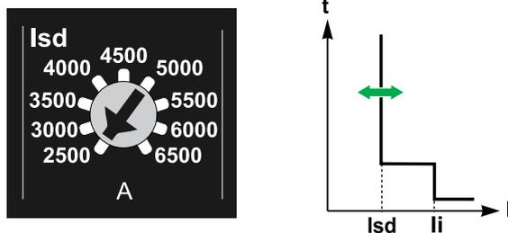
下表显示了与  $I_{sd}$  旋钮位置相应的短延时保护吸合电流  $I_{sd}$  值 ( 安培 ) ( 值通过旋钮指示 )，并且还显示了瞬时保护吸合电流  $I_i$  值。
