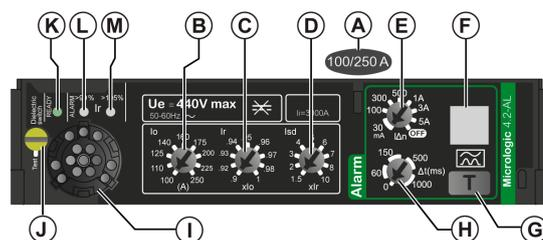
**A** MicroLogic 电子脱扣单元设置范围
