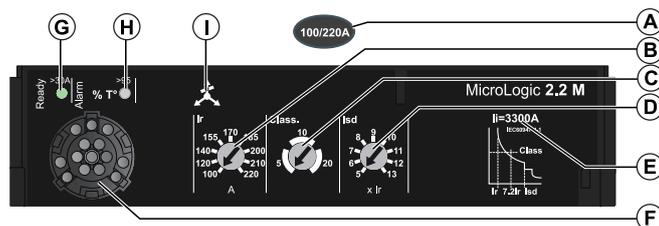
A MicroLogic 电子脱扣单元设置范围
