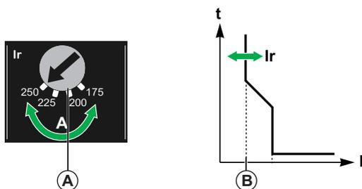
下表显示了对应每一个脱扣单元额定值、与旋钮  $I_r$  位置相应的热保护吸合电流  $I_r$  值（安培）（值通过旋钮指示）。
