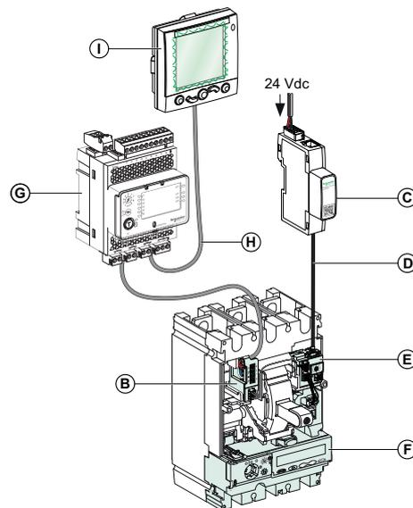
示例 2：将 IFM 通讯接口连接到 MicroLogic 5、6 或 7 脱扣单元
