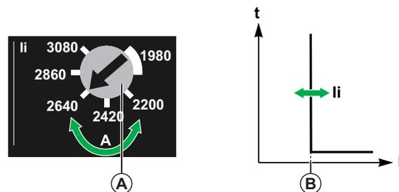
下表显示了对应每一个脱扣单元额定值、与旋钮 li 位置相应的磁保护吸合电流 li 值 (安培) (值通过旋钮指示)：
