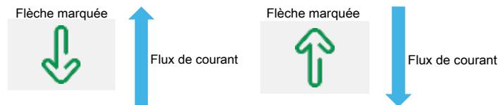
Les figures suivantes montrent l'emplacement de la flèche sur les PowerTag Energy F160 et Rope :
