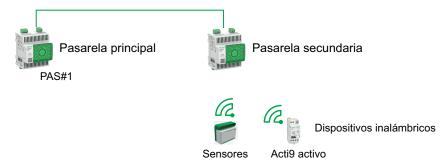
**NOTA:** El y le permiten visualizar datos de dispositivos inalámbricos conectados a una pasarela secundaria. La pasarela del principal supervisa el estado de la comunicación Modbus TCP/IP de la pasarela secundaria y sus dispositivos inalámbricos aguas abajo, e informa de una alarma cuando esta se desconecta.
