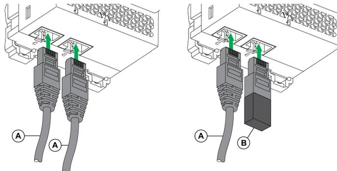
**A** Cable NSX o enchufe RJ45/ cable ULP del enchufe
