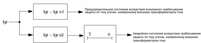
Защита по току утечки, измеренному внешним трансформатором тока: переход в предупредительное и аварийное состояние
