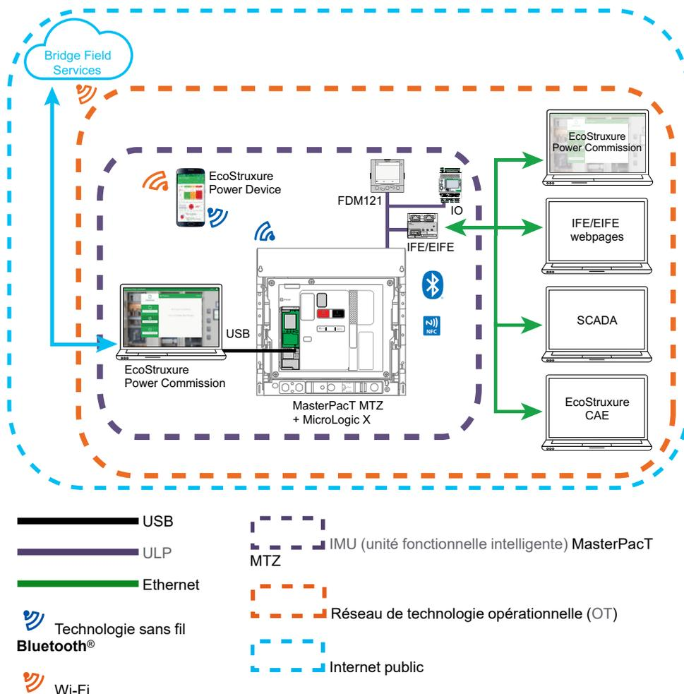
L'unité fonctionnelle intelligente (IMU) MasterPacT MTZ englobe le disjoncteur, l'unité de contrôle MicroLogic X ainsi que les modules ULP, l'interface de communication et les modules IO associés.
