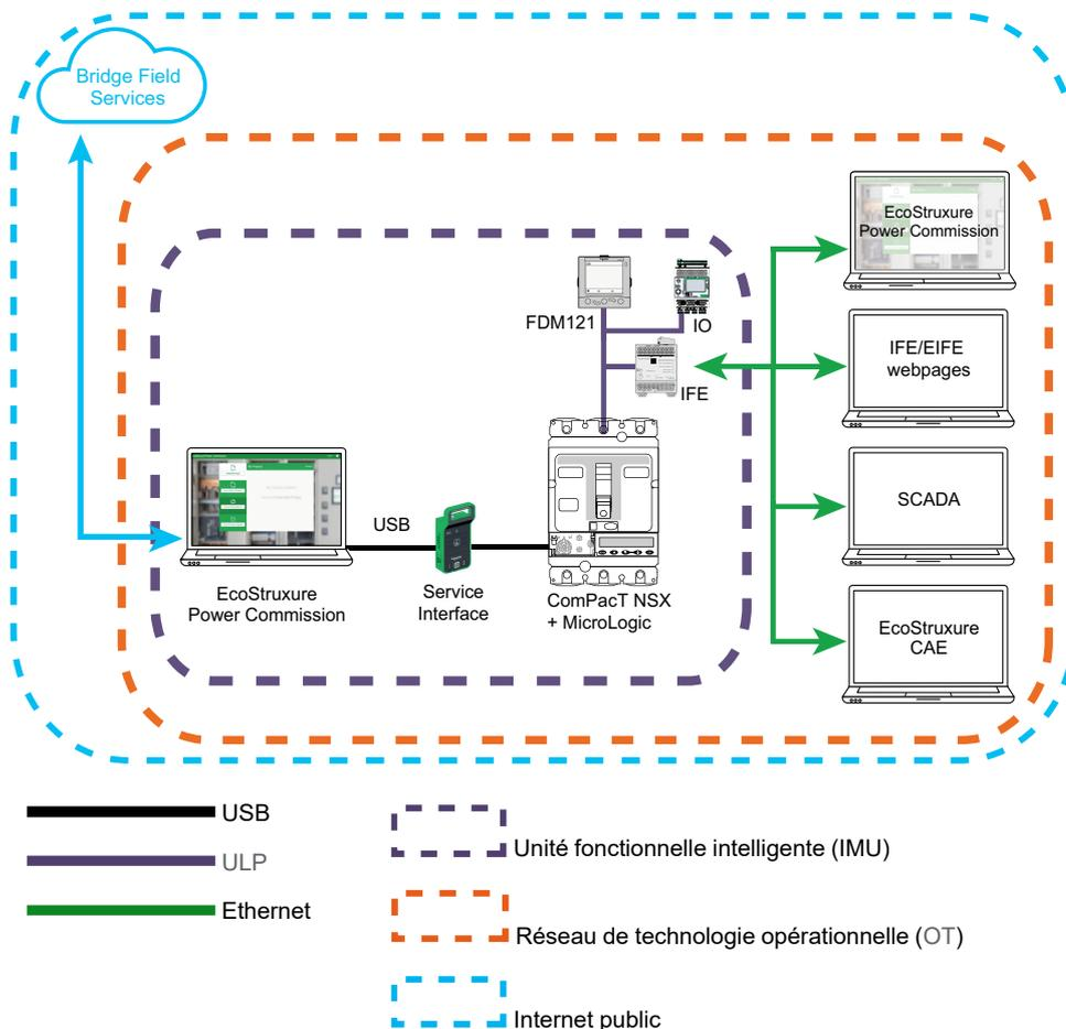
L'unité fonctionnelle intelligente (IMU) englobe le disjoncteur ComPacT NSX ou PowerPacT à châssis H, J ou L, le déclencheur MicroLogic ainsi que les modules ULP, l'interface de communication et les modules IO associés.
