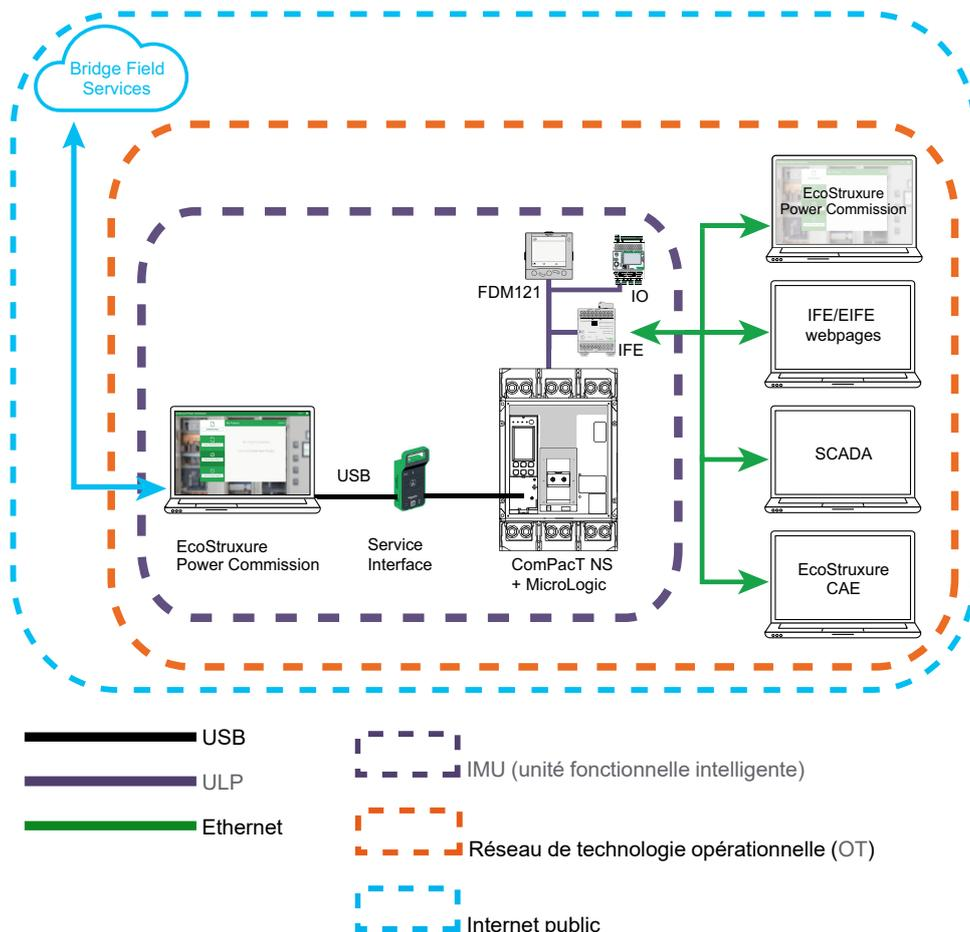
L'unité fonctionnelle intelligente (IMU) englobe le disjoncteur MasterPacT NT/NW, ComPacT NS ou PowerPacT à châssis P ou R, le déclencheur MicroLogic ainsi que les modules ULP, l'interface de communication et les modules IO associés.
