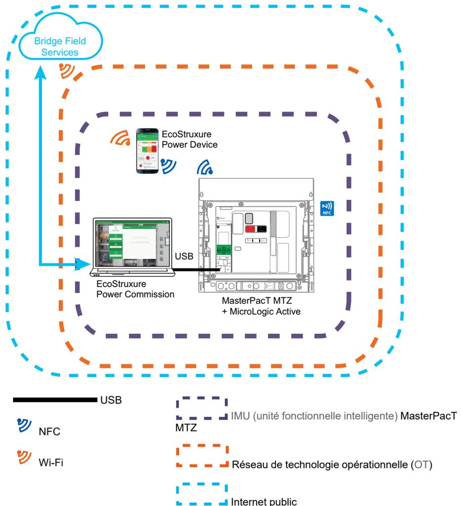
L'unité fonctionnelle intelligente (IMU) MasterPacT MTZ englobe le disjoncteur, l'unité de contrôle MicroLogic Active et l'interface de communication.
