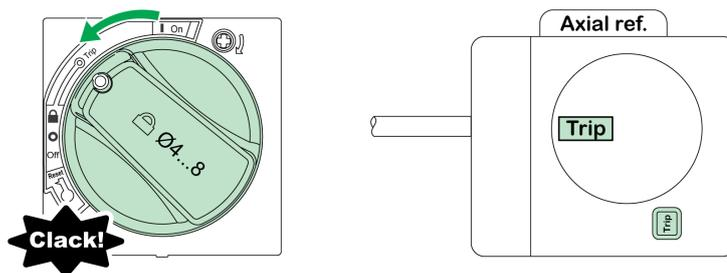
在脱扣后，利用侧面旋转手柄复位断路器的方式与利用延伸旋转手柄复位断路器的方式相同，54 页。
