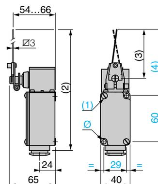
(1) Fixation arrière : par 2 vis M5.
