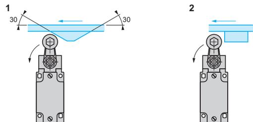
Montage et fixation des interrupteurs de position par la tête
