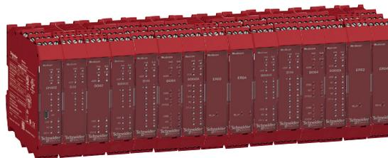
Configuration matérielle maximale : une unité centrale de contrôleur de sécurité raccordée à 14 modules d'extension (1) via les connecteurs d'extension en fond de panier : 128 entrées + 16 paires OSSD ou 32 OSSD simples + sorties d'état
