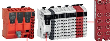
Entrées/sorties optimisées avec Modicon TM3 : entrées/sorties distribuées sur Ethernet avec coupleur de bus TM3
