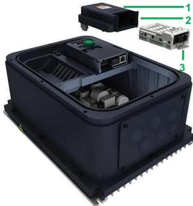
Exemplo de instalação de um módulo de comunicação 3 (vista de baixo) em um inversor com bloco de controle compacto
