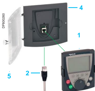
Usando o terminal do display gráfico remoto na porta do painel: 1 + 2 + 4 (+ 5, se IP 65)
