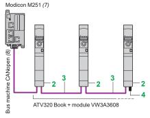
Solution optimisée pour le raccordement en chaînage sur bus machine CANopen
