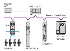
Exemple de configuration sur bus machine CANopen
