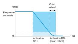
Activation de la fonction de sécurité GDL (exemple d'arrêt type SS1)
