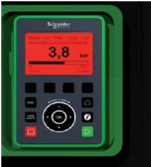
Falha detectada: A luz de fundo vermelha é ativada automaticamente
