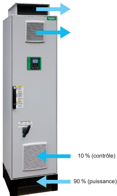
Système de refroidissement avec deux flux d'air séparés
