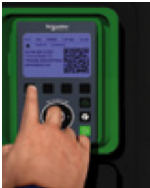
Integrierte dynamische QR-Codes für kontextsensitiven, sofortigen Zugriff auf die Online-Hilfe
