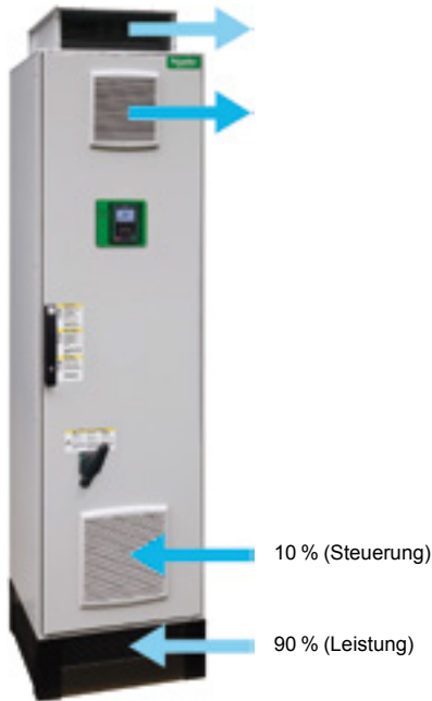
Kühlsystem mit zwei separaten Luftströmen
