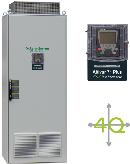
Armoire IP 23 ou IP 54 "prête à l'emploi" avec filtrage des harmoniques et fonctionnement 4 quadrants
