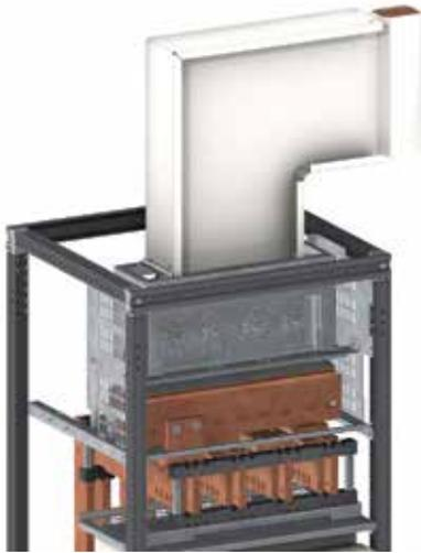
Les tableaux peuvent être équipés de raccordements pour Canalis KT. L'éclissage avec le tableau se fera par l'intermédiaire d'un élément de ligne standard (élément droit, coude, etc.) et un bloc de jonction identique au raccordement entre élément de ligne. L'arrivée de la canalisation électrique préfabriquée se fait par le dessus du tableau (toit).
