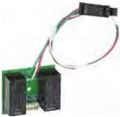
Contactos programables M2C: relé interno del interruptor automático con dos contactos.
