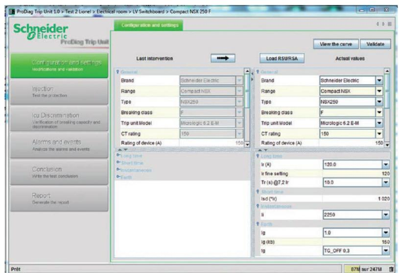
Fig. 1. ProDiag Trip Unit Manager: configuración y parámetros. ProDiag Trip Unit Manager V1.0 es el software de propiedad exclusiva que utilizan los especialistas de Schneider Electric para llevar a cabo el diagnóstico ProDiag Trip Unit durante una intervención de mantenimiento exclusiva (L4).
