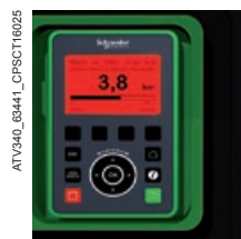
Ermittelte Störung: Die Hintergrundbeleuchtung des roten Bildschirms wird automatisch aktiviert.
