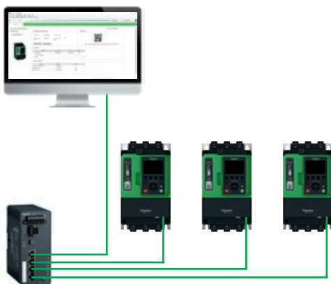
Gleichzeitiger Firmware-Upload mehrerer ATS490-Sanftanlasser über Modbus TCP/EtherNet/IP oder serielle Modbus-Schnittstelle unter Verwendung von EcoStruxure Automation Device Maintenance
