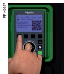
Integrierte dynamische QR-Codes für kontextsensitiven, sofortigen Zugriff auf die Online-Hilfe
