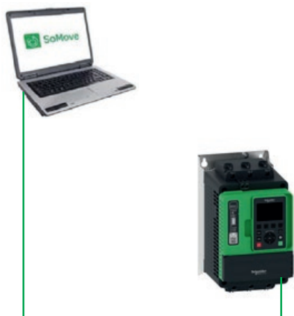
Firmware-Aktualisierung über Modbus TCP/Ethernet/IP oder Modbus seriell über SoMove
