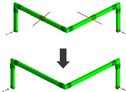
3. Замена окрашенных кронштейнов для крепления шинопроводов **Canalis KB** на кронштейны с гальваническим покрытием.
