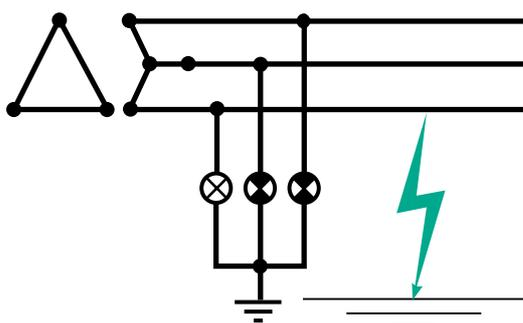
**Fig. 3** : contrôleur d'isolement à lampe dans l'industrie.
