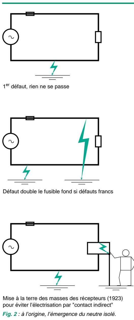
**Fig. 2** : à l'origine, l'émergence du neutre isolé.
