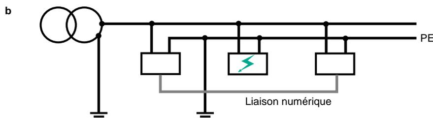
En TT : avec une seule prise de terre des masses des récepteurs, toutes les masses sont au même potentiel, même pendant un défaut ; pas de perturbations des communications par bus.
