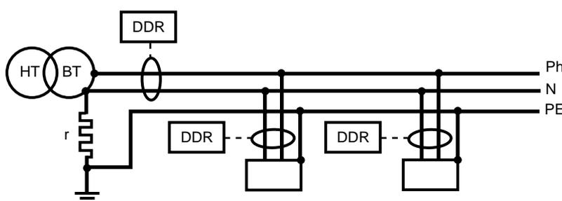
Pour conserver l'avantage du faible courant de défaut (dégâts et CEM) apparition d'un TT impédant ( $r \approx 12\Omega/Id = 20 \text{ A}$ ) avec une seule prise de terre. Ce schéma nécessite l'utilisation d'un limiteur de surtension si le courant homopolaire dépasse  $\approx 80 \text{ A}$ . Même emploi des DDR (sélectivité chronométrique).
