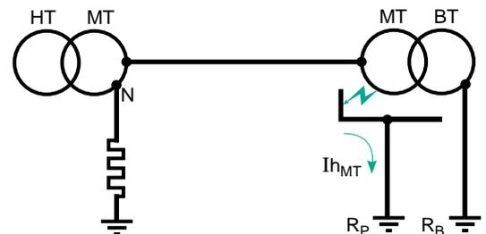
Fig. 9a : si  $R_p$  et  $R_b$  sont reliées, le courant de défaut fait monter le potentiel des réseaux BT par rapport à la terre.
