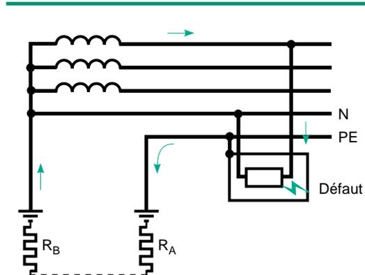
Fig. 7 : schéma TT.
