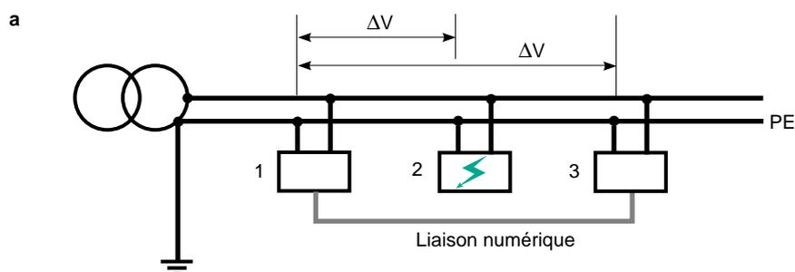
En TN : lors du défaut d'isolement, la chute de tension dans le PE fait varier le potentiel de référence des appareils communicants.
