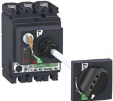
Kilit seçeneği ve anahtarlar panonun arka kısmına monte edilmiş uzatmalı döner kurma kollu Compact NSX.
