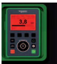
Defecte detectate: Backlit-ul roșu al ecranului este activat automat
