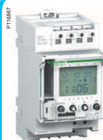
IC Astro Fonctionne sans cellule photoélectrique et calcule les heures de lever et de coucher du soleil en fonction de sa position géographique. Personnalisable à l'aide de sa fonction de programmation.
