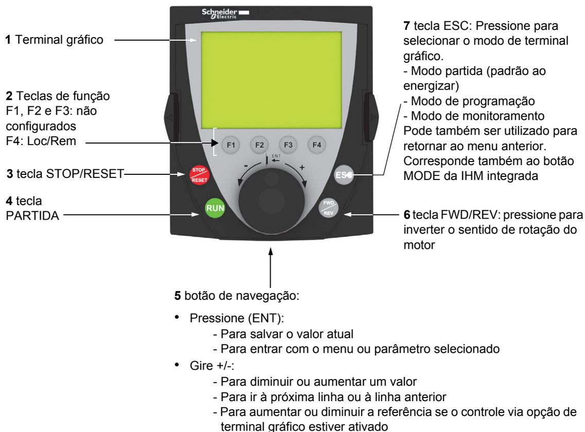
**Observação:** Teclas **3**, **4**, **5** e **6** podem ser utilizadas para comandar diretamente o inversor, se o comando via opção de terminal gráfico estiver ativado.
