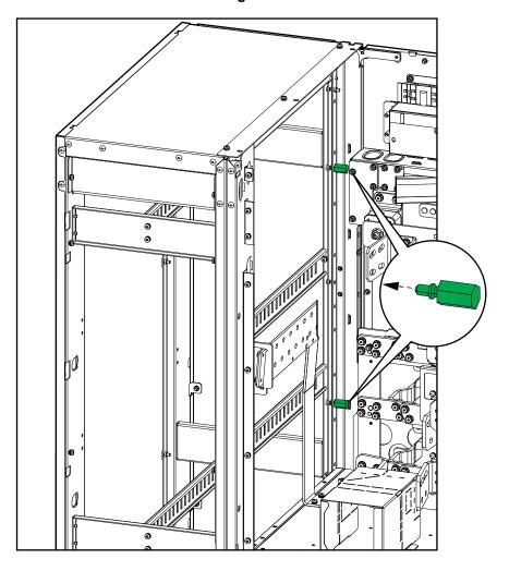
13. Fare passare i cavi di segnale attraverso l'armadio con ingresso dal fondo e nell'UPS. Posizionare i cavi di segnale come mostrato in figura per separare i cavi Class 2/SELV dai cavi non-Class 2/non-SELV. Un divisore all'interno del canale cavo nell'UPS separa i cavi. Seguire le istruzioni riportate nel manuale di installazione dell'UPS per collegare i cavi di segnale.
