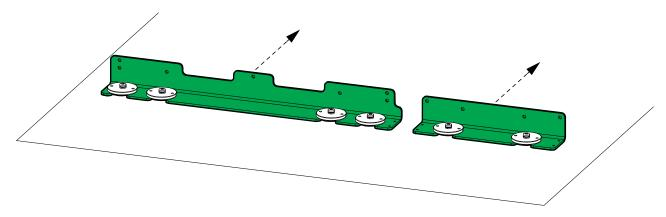
5. Installare le staffe di ancoraggio posteriori sull'UPS e l'armadio con ingresso dal fondo con i bulloni M8x25 in dotazione.
