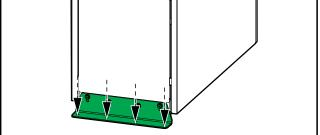
4. Abbassare i piedini di livellamento anteriori e posteriori sull'armadio con ingresso sul fondo con una chiave inglese finché non si appoggiano al pavimento. Le ruote non devono entrare in contatto con il pavimento. Utilizzare una livella a bolla per verificare la messa in piano dell'armadio con ingresso dal fondo.
