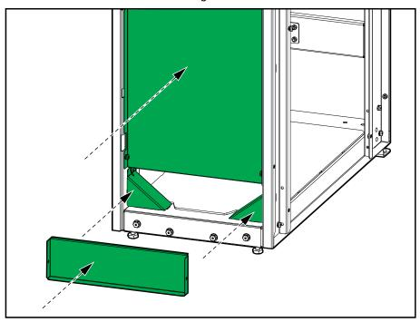
16. **Per l'ancoraggio antisismico:** Installare la staffa di ancoraggio antisismico anteriore del kit antisismico opzionale GVLOPT002 sull'UPS e sull'armadio con ingresso dal fondo e montare le staffe anteriori antisismiche al pavimento. Utilizzare le parti di montaggio appropriate per il tipo di pavimento: il diametro del foro nella staffa di ancoraggio anteriore è di ø14 mm. Il requisito minimo delle parti di montaggio è: grado di resistenza M12 8.8.
