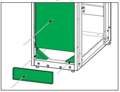
20. **Per l'ancoraggio antisismico:** Installare la staffa di ancoraggio antisismico anteriore del kit antisismico opzionale GVLOPT002 sull'UPS e sull'armadio con ingresso dal fondo e montare le staffe anteriori antisismiche al pavimento. Utilizzare le parti di montaggio appropriate per il tipo di pavimento: il diametro del foro nella staffa di ancoraggio anteriore è di ø14 mm. Il requisito minimo delle parti di montaggio è: grado di resistenza M12 8.8.
