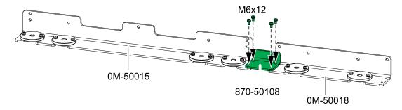
Fissare il gruppo di ancoraggio posteriore al pavimento. Utilizzare le parti di montaggio appropriate per il tipo di pavimento: il diametro dei fori nell'ancoraggio posteriore è di ø16 mm. Il requisito minimo delle parti di montaggio è: grado di resistenza M12 8.8.
