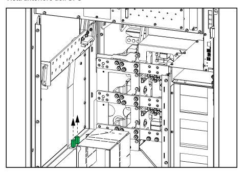
11. Installare due viti del kit di installazione 0H-1818 per fissare nuovamente la sbarra di rame al ripiano.
