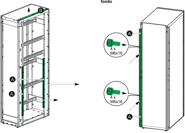
3. Spingere l'armadio con ingresso dal fondo nella posizione finale. Eseguire l'allineamento con l'ancoraggio antisismico, se presente. Per sistemi senza ancoraggio antisismico, reinstallare la staffa di trasporto posteriore sul retro dell'armadio con ingresso dal fondo e montarla sul pavimento.
