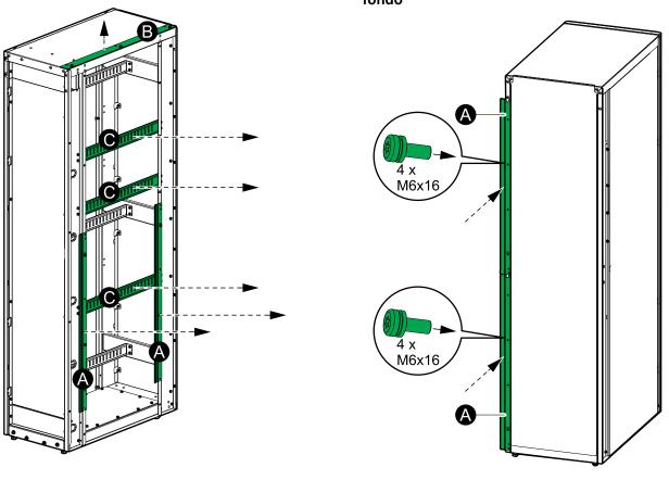
3. Installare le due piastre laterali (TME38565) del kit opzionale GVLOPT012 sul lato destro dell'armadio con ingresso dal fondo.
