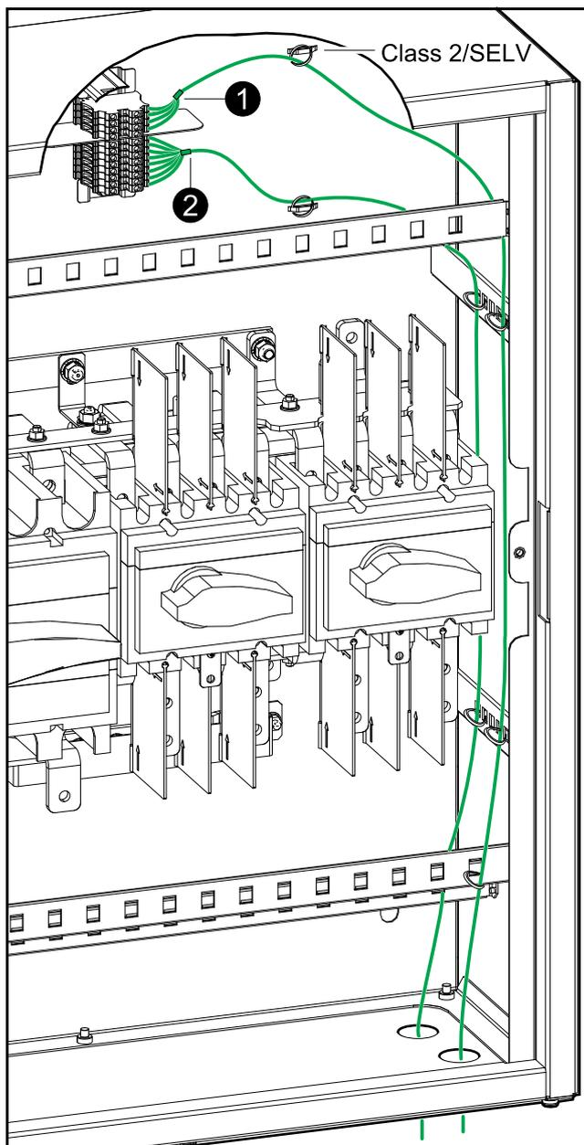
1. Collegare i cavi di segnale Class 2/SELV per le spie dei sezionatori dalla morsettiera di controllo nel pannello bypass di manutenzione all'UPS secondo la propria configurazione.
