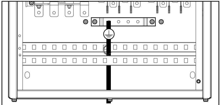
3. Reinstallare la copertura della sbarra PE.
