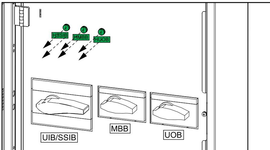
2. Installare tre tappi di chiusura tondi (non forniti) nei fori della porta interna.
