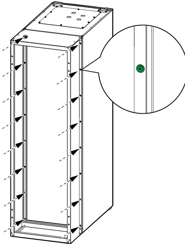
6. Empuje el SAI con el adaptador de profundidad hasta su posición final.
