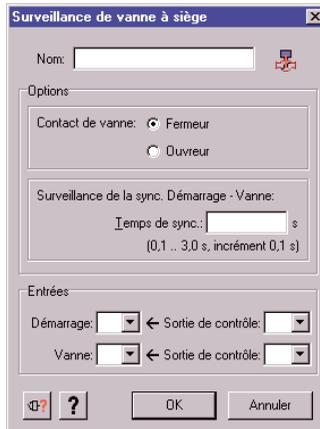
Lorsque le contact de la vanne est ouvert, la sortie du composant est immédiatement activée après un démarrage et reste active jusqu'à la fin du temps de synchronisation ajusté. La sortie ne reste ensuite activée, que lorsque le contact de la vanne à entre-temps fermé. Dans le cas contraire la sortie s'ouvre de nouveau.
