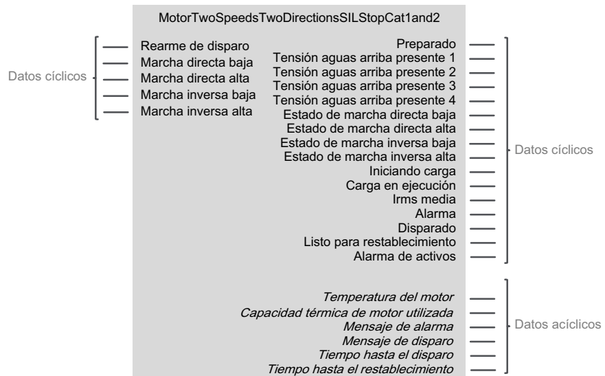
Figura 22 - Bloque funcional MotorTwoSpeedsTwoDirectionsSILStopCat1and2
