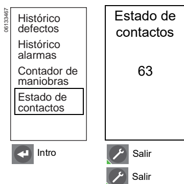
Figura 86 – Verificación del desgaste de contactos
