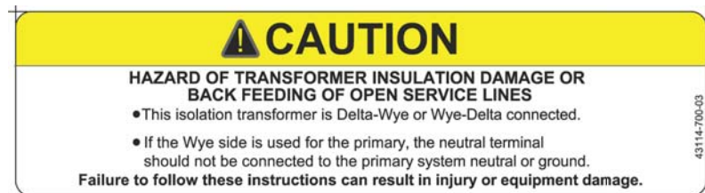
Figura 32: Etiqueta de precaución para los transformadores conectados en delta-estrella o estrella-delta
