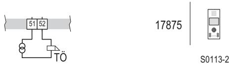
**Schaltplan:** Schalten z. B. eines Etagentüröffners mit der Sondertaste, oder Auslösen der Türöffnerautomatik über den Etagendrucker.
