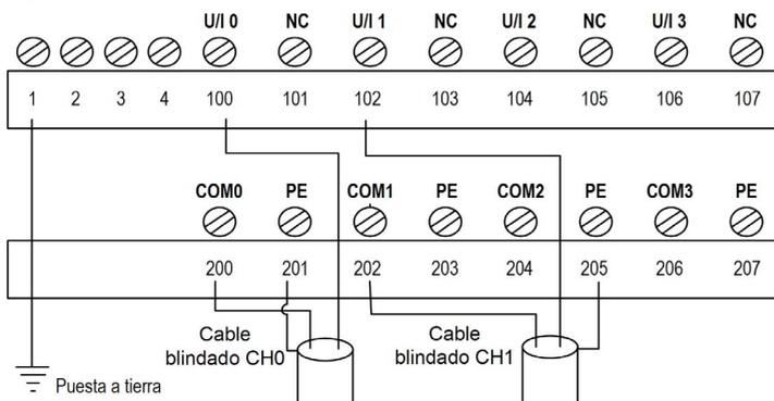
En la tabla siguiente se muestra la distribución de los canales analógicos en el bloque de terminales TELEFAST ABE-7CPA21 con un cable BMX FCA \*\*0:
