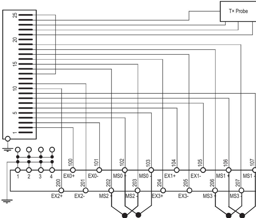
**Leyenda:** Funcionamiento en modalidad TC con compensación interna de unión en frío Telefast.
