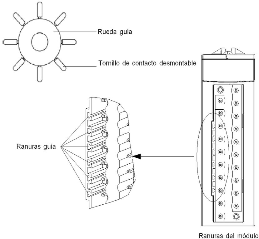
En el diagrama siguiente se muestra un ejemplo de configuración de codificación que posibilita el ajuste del bloque de terminales al módulo.
