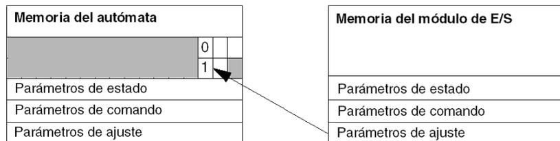
Cuando se intercambian datos entre la memoria del autómatas y el módulo, el reconocimiento por parte del módulo se gestiona mediante el bit `ADJ_ERR` (`%MWr.m.c.1.2`) que, según su valor, proporciona el siguiente informe:
