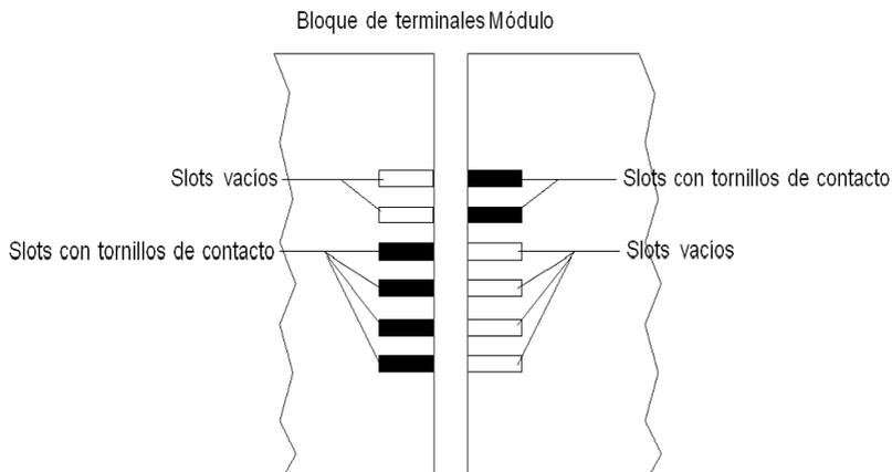
En el diagrama siguiente se muestra un ejemplo de configuración de codificación que no posibilita el ajuste del bloque de terminales al módulo:
