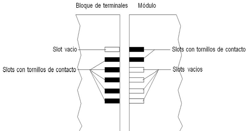
**NOTA:** El conector del módulo dispone de indicadores que muestran la dirección correcta que debe utilizarse para instalar bloques de terminales.
