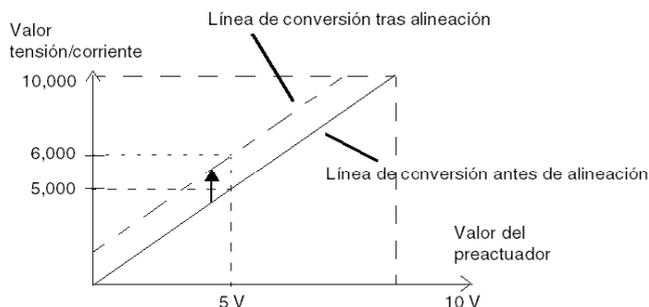
El valor de alineación puede editarse mediante una consola de programación, incluso si el programa está en modalidad de ejecución. Para cada canal de salida, puede:
