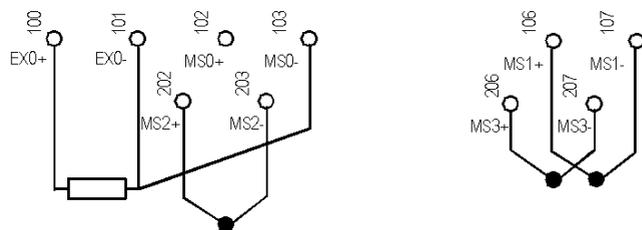
**Legenda:** Funcionamiento en modalidad TC con compensación de unión en frío y una sonda PT100 de 3 conductores.
