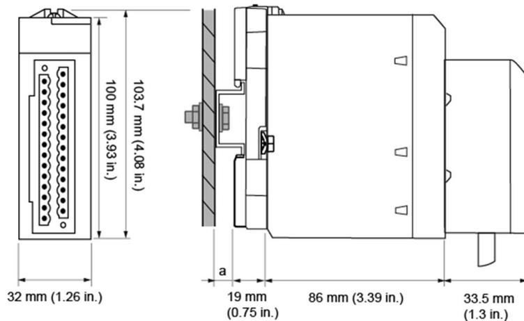
a Profundidad del segmento DIN: el valor dependerá del tipo de segmento DIN que se utilice en la plataforma. Consulte *Montaje de los bastidores (véase Modicon X80, Bastidores y fuentes de alimentación, Hardware Manual de referencia)*.
