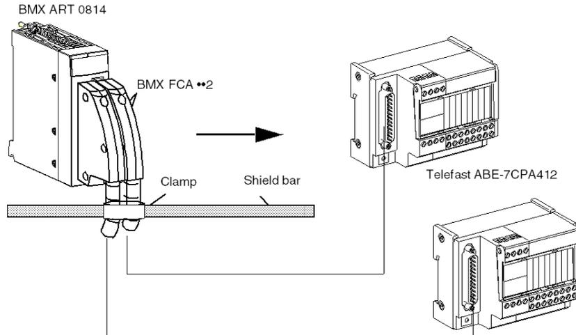
El accesorio TELEFAST ABE-7CPA412 es una unidad de base utilizada para conectar módulos analógicos de cuatro canales a bloques de terminales de tornillos.
