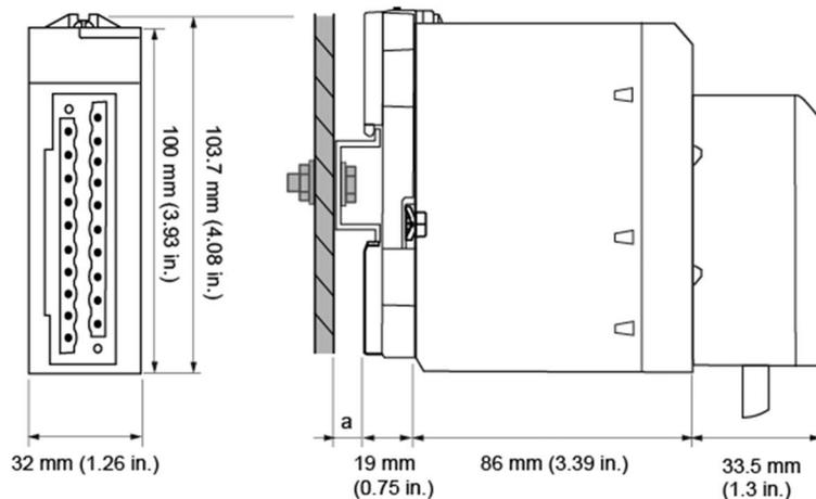
a Profundidad del segmento DIN: el valor dependerá del tipo de segmento DIN que se utilice en la plataforma.
