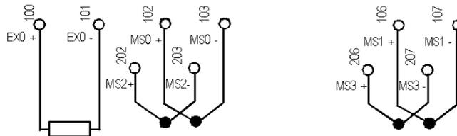
**Leyenda:** Funcionamiento en modalidad TC con compensación de unión en frío y una sonda PT100 de 2 conductores.
