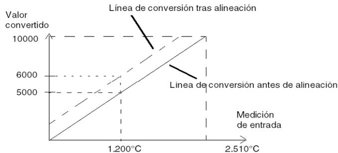
El valor de alineación puede editarse mediante una consola de programación, incluso si el programa está en modalidad de ejecución. Para cada canal de entrada, es posible:
