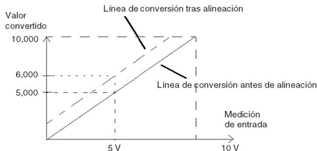
El valor de alineación puede editarse mediante una consola de programación, incluso si el programa está en modalidad de ejecución. Para cada canal de entradas se puede:
