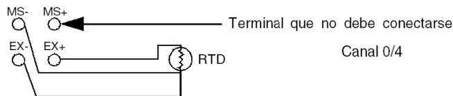
**NOTA:** Para el módulo BMX ART 0814, los valores CJC de los canales 4 a 7 también se pueden utilizar para los canales 0 a 3. Por lo tanto, sólo un sensor externo CJC (*véase página 155*) está conectado al canal 4.
