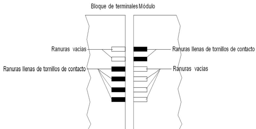
En el diagrama siguiente se muestra un ejemplo de configuración de codificación que no posibilita el ajuste del bloque de terminales al módulo.
