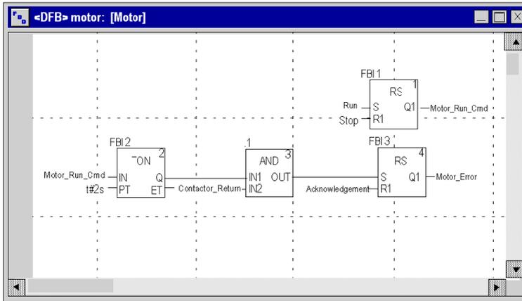
Cuando Run = 1 y Stop = 0, el motor puede controlarse (Motor\_Run\_Cmd = 1). La otra parte supervisa la variable Contactor\_return. Si Contactor\_return no se establece en "1" después de que el contador binario cuente dos segundos, la salida Motor\_error pasa a "1".
