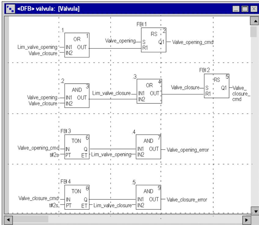
Este DFB autoriza que el comando pueda abrir la válvula (Valve\_opening\_cmd) cuando las entradas Valve\_closure y Lim\_valve\_opening se establezcan en "0". El principio es el mismo para el cierre, con una función de seguridad adicional en caso de que el usuario solicite la apertura y el cierre de la válvula a la vez (la acción de apertura tiene prioridad).
