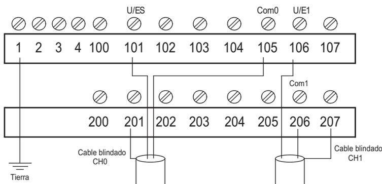
En la tabla siguiente se muestra la distribución de las salidas analógicas en el bloque de terminales TELEFAST ABE-7CPA21 con un cable BMX FCA \*\*0:
