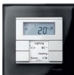
Bouton-poussoir KNX double plus avec thermostat d'ambiance intégré
