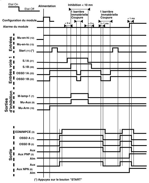
Mode de "Verrouillage du démarrage/redémarrage" avec 4 capteurs
